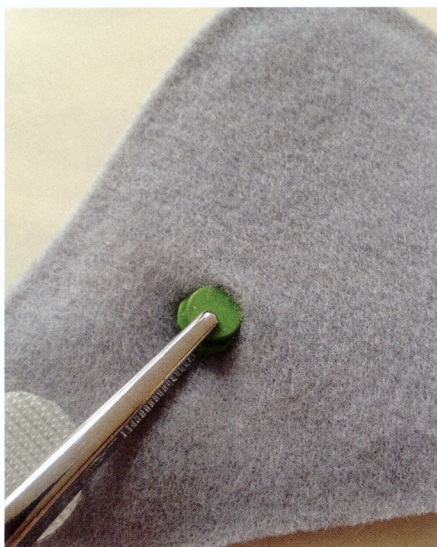
Abb. 8 Sensor beim Einbringen in ein Polstermaterial.
