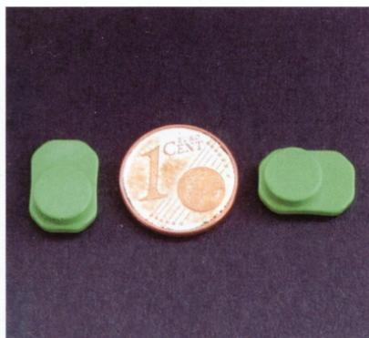
Der Sensor von Orthotimer erfasst über die Temperatur die Tragezeit von Hilfsmitteln.
